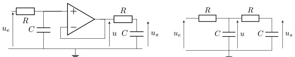
1. Déterminez la fonction de transfert du filtre de gauche (avec ALI). La mettre sous la forme  $H = \frac{1}{1 - x^2 + j\frac{1}{Q_0}x}$  avec  $x = \frac{\omega}{\omega_0} = RC\omega$  et  $Q_0$  à déterminer.
