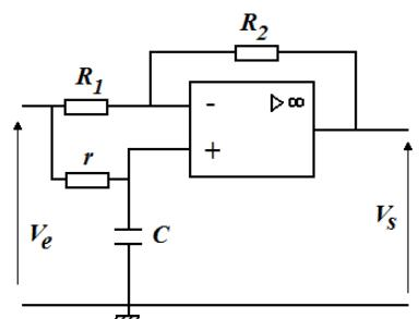
2. Quelle doit être la relation entre  $R_1$  et  $R_2$  pour que le gain soit égal à l'unité ?
