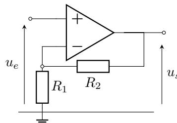
Il y a une rétroaction négative donc l'ALI, que l'on suppose idéal, fonctionne en régime linéaire. On en déduit que  $u_e = V_+ = V_-$ .
