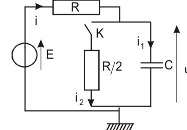
On associe le complexe  $\underline{u} = U\sqrt{2}\exp(j(\omega t + \varphi)) = \underline{U}\exp(j\omega t)$  à la tension  $u(t) = U\sqrt{2}\cos(\omega t + \varphi)$  où  $\underline{U} = U\sqrt{2}\exp(j\varphi)$ . De même,  $\underline{E} = E\sqrt{2}$ .
