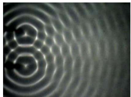
On réalise maintenant des interférences à la surface de l'eau. Deux points sources synchrones, notés  $S_1$  et  $S_2$  vibrant en phase et ayant la même amplitude  $a$  émettent chacun une onde progressive. On s'intéresse à la zone où les deux ondes interfèrent.
