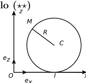
La roue roule sans glisser sur le sol de manière à ce que le point  $C$  suive une trajectoire rectiligne uniforme de vitesse  $\vec{v}_C = v_C \vec{e}_x$ . Le mouvement est donc dans le plan  $(Oxz)$ . À  $t = 0$ , le point  $C$  a pour coordonnées cartésiennes  $(0, R)$  et la valve est en  $O$ .
