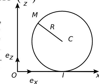
La roue roule sans glisser sur le sol de manière à ce que le point  $C$  suive une trajectoire rectiligne uniforme de vitesse  $\vec{v}_C = v_C \vec{e}_x$ . Le mouvement est donc dans le plan  $(Oxz)$ . À  $t = 0$ , le point  $C$  a pour coordonnées cartésiennes  $(0, R)$  et la valve est en  $O$ .
