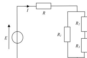
3. Exprimer la résistance équivalente  $R_{eq}$  des deux résistances en parallèle en fonction de  $R_1$  et  $R_2$ , puis calculer sa valeur.
