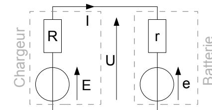
Dans toute la suite, on suppose que la tension à vide  $E$  du chargeur est supérieur à la f.e.m de la batterie  $e$ .
