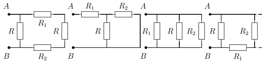
1. Les résistors  $R$ ,  $R_1$  et  $R_2$  sont-ils en série, en parallèle ou ni l'un ni l'autre ? Déterminez, si possible, la résistance équivalente comprise entre les points  $A$  et  $B$
