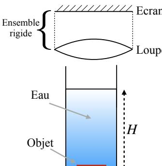
1. On considère un point objet  $A$  au centre de la pièce. Identifier à l'aide d'une construction graphique la position de son image  $A'$  pour le dioptre plan eau/air.
