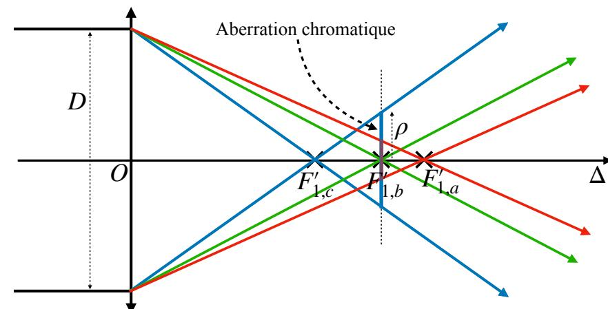
Ainsi, une tache colorée (irisée) apparaît au niveau du foyer image  $F'_{1,b}$ . Sur le schéma, la tache bleue (associée à  $\lambda_c$  dans la suite de l'exercice) semble plus large que la tache
