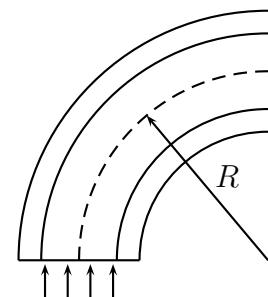
La fibre est éclairée par un faisceau parallèle avec un angle d'incidence nul.
