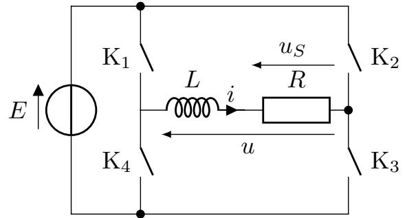
Les quatre interrupteurs bidirectionnels  $K_1$ ,  $K_2$ ,  $K_3$  et  $K_4$  sont commandés électriquement de telle façon que :
