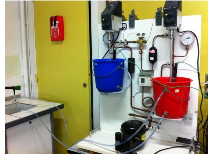
FIGURE I.4 – Pompe à chaleur avec dispositif de refroidissement
